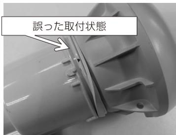
左の写真の様にパッキンが捲れた状態では、防水性能が保てず、隙間から雨水等が入り漏電する可能性がありますので、上の写真の様に正しく取り付けられた事を必ず確認して下さい。
