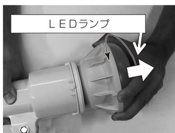
既設ランプの取り付け時と同様に、時計回りになる程度回していくと、口金部分が掛かります。掛かった後は、ランプを引っ張ってバネを伸ばしながら回し、最後まで回しきった時点で引っ張る事を止め、ランプと防水パッキンを確実に密着させて下さい。
