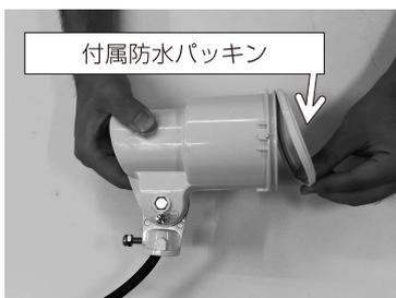
既設からのランプ交換の場合は既設の防水パッキンが経年劣化し防水性能が保てない事があります。既設の防水パッキンを外し、本ランプ付属の防水パッキンと交換します。
