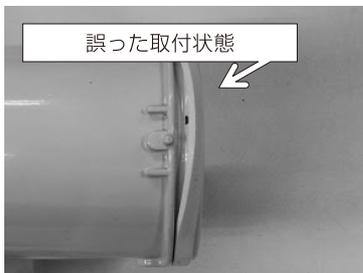
左の写真の様にパッキンがめくれた状態では、防水性能が保てず、隙間から雨水等が入り漏電する可能性がありますので、上の写真の様に正しく取り付けられた事を必ず確認して下さい。
