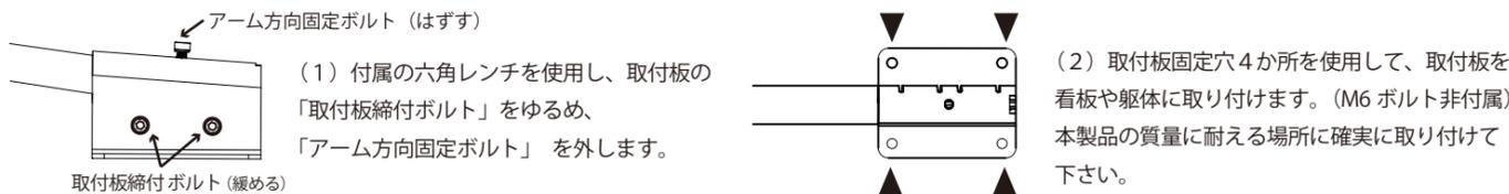
(1) 付属の六角レンチを使用し、取付板の「取付板締付ボルト」をゆるめ、「アーム方向固定ボルト」を外します。
