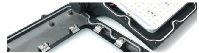
LED投光器の最も重要なテーマである防水性能。ビューフラッドでは防水性能の要であるパッキンを2重に配置。発光面には収縮変形しやすい樹脂ではなく強化ガラスを採用。これをパッキンと多数のロック金具で抑え、強力な防水構造を実現。
