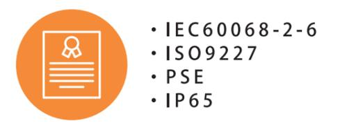
高所看板で使うものですので電気用品安全法(PSE)、IP65(防水防塵試験)、耐振動試験(IEC60068-2-6)、塩水噴霧試験(ISO9227)に適合クリアしております。
