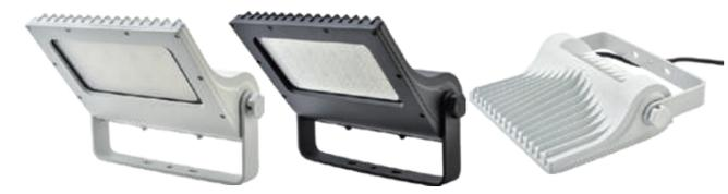
VF120は看板H寸法4M～5.5Mの大型サイン用のLED投光器です。消費電力は125Wのハイパワー。柔らかい光の広角105度と、しっかり飛ばす狭角30度の2種配光に加え、白と黒から選べる本体カラーを設定。
