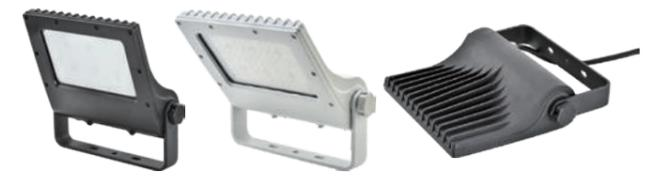
VF80はVF40よりも一回り大きいボディサイズで、看板H寸法3M～4.5Mの中型サインに最適な消費電力75W。柔らかい光の広角105度と、しっかり飛ばす狭角30度の2種配光に加え、白と黒から選べる本体カラーを設定。
