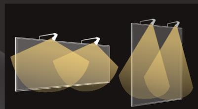
ViewLampは横型看板用の広角配光タイプと、縦型看板用の狭角配光タイプの2種類の配光をご用意。設置する看板に合わせて最適な配光をお選び頂けます。
