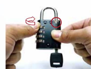
マスターキーで開錠した後、シャックルガードが開いた状態を保ち、ダイヤルを回し検索していきます。
